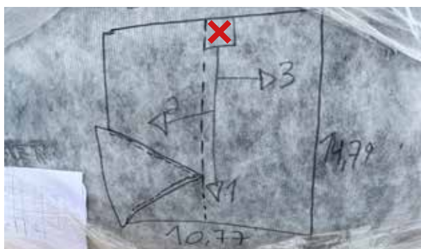
Schets met beginpunt en de geplande volgorde voor het uitrollen en ontvouwen van de folie
